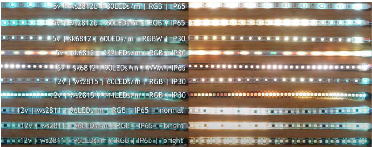
Figure n°31 : Photogrammes d'une video de la chaîne Youtube (Intermit.Tech) présentant les différents types de LED adressables.
