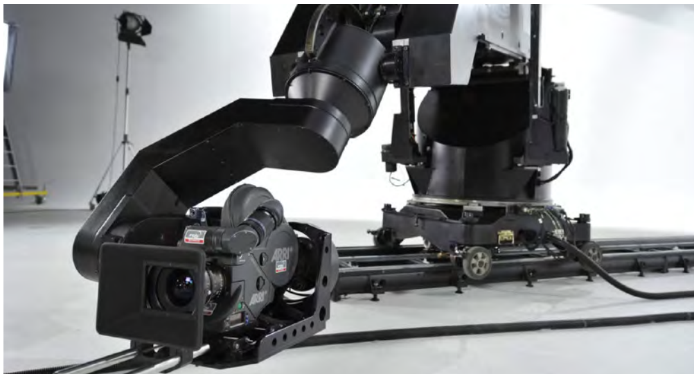
Figure n°23 : Exemple de robot de motion control
