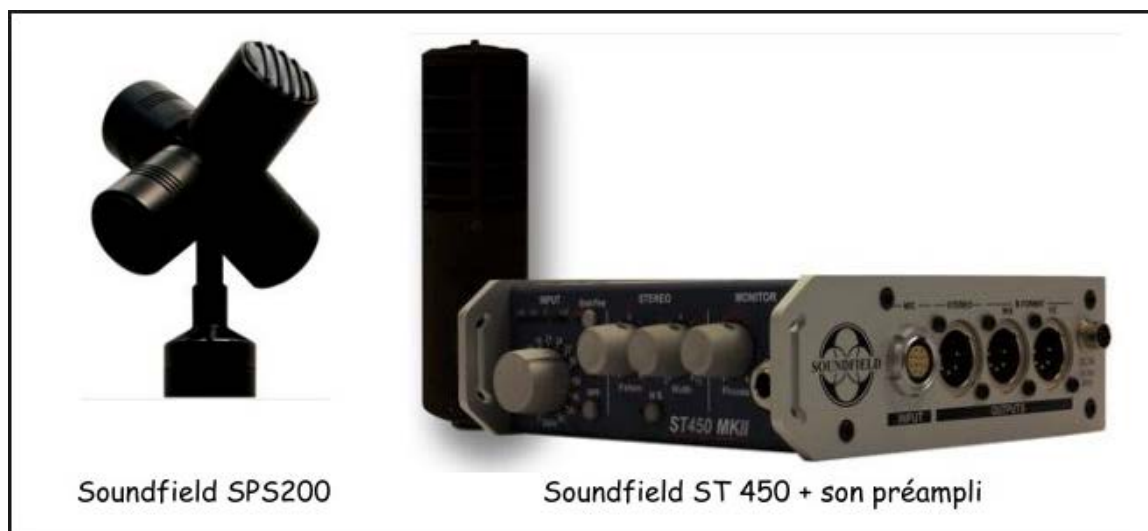
Exemple de microphones Soundfield. Philippe Barbeau utilisait le 450 pour la technologie de format B
