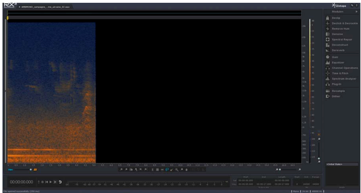
Capture d'écran de l'ambiance sonore analysée avec le plug-in iZotope RX4. L'avion apparaît sous forme de deux traces droites et horizontales continues.
