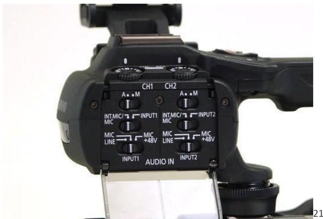
Nous observons donc deux petits rotatifs en haut, ils nous permettent de régler le niveau d'entrée. En dessous, trois réglages sont possibles.
